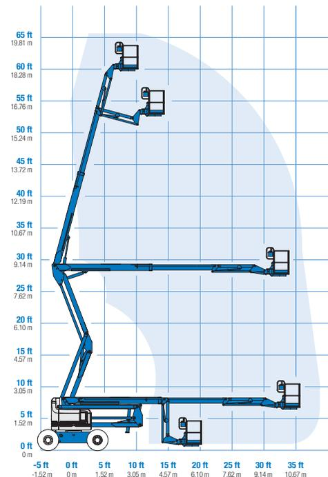
\* Altura de trabajo = Altura de la plataforma + 2 m
